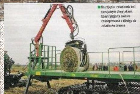
Na zdjęciu: załadowarka bali specjalnym chwytnikiem. Konstrukcja ta została zaprojektowana z dalażgu do załadunku drewna.
